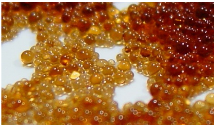
Obrázek 32: Matrice iontoměniče vyrobená na bázi syntetické pryskyřice
