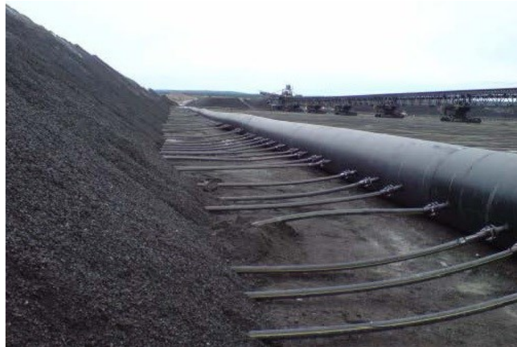
Obrázek 28: Systém vzduchování haldy Talvivaara
